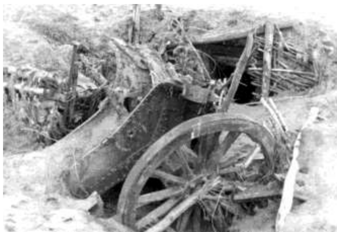
L'éclatement prématuré a fracassé le tube et détruit l'affût du canon
